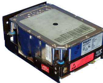
Illustration 6: Disque dur Maxtor 5,25 pouces
